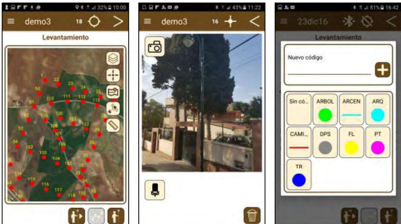
El levantamiento continuo permite grabar puntos automáticamente especificando un intervalo de distancia o tiempo. Si se corresponden a elementos lineales se unirán los vértices, pudiendo obtener de forma inmediata el perímetro o área del contorno medido. Otras utilidades nos permiten hallar las distancias 2D, 3D y diferencia de cotas entre puntos, o bien el área formada por un polígono.
