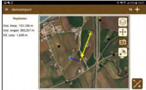
El replanteo de líneas indica en tiempo real la distancia a la línea formada por dos puntos previamente designados.
